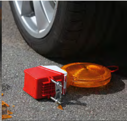
Test de résistance à l'écrasement d'un produit Nissen
