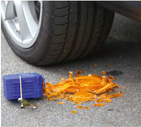
Test de résistance à l'écrasement d'un produit bas de gamme
