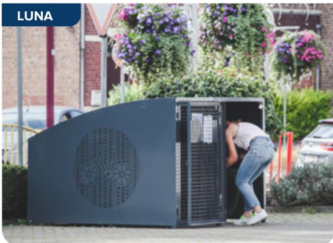
Structure acier galvanisé peint | Porte grillagée battante maille 20x20 mm | Dimensions 2055x900xH1450 mm | Capacité 1 vélo | Modules complémentaires pour rangées | Fermeture par cadenas | Finition RAL au choix, mono ou bicolore | Rail de guidage, crochet intérieur, emplacement signalétique | Fixation par ancrage
