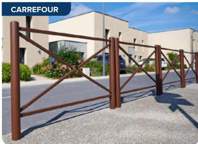
Tube acier Ø76mm avec bouchon bombé soudé | Hauteur hors sol 1025mm | Longueurs 1072 ou 1572mm | Cadre simple croix | Acier peint sur zinc selon coloris | Fixation : scellement direct (platines en option)
