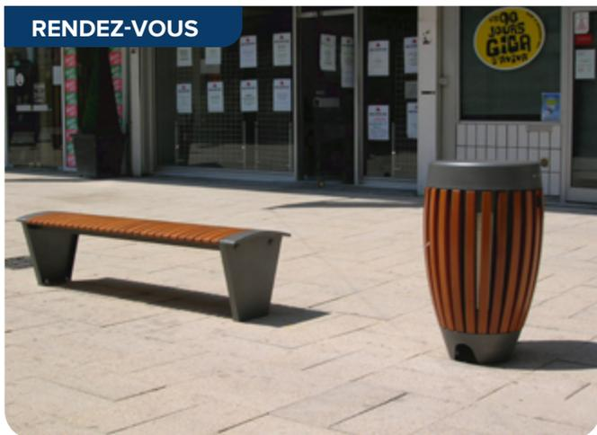
Corps et socle en acier zingué | Couvercle en fonte d'aluminium | Habillage en bois exotique brut ou lasuré (frêne, acajou, noyer) | Bac intérieur en acier inox (avec ou sans porte-sac) | Contenance 55 L
