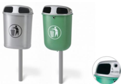
Corps en PEHD vert (option orange) ou acier galvanisé brut/laqué (RAL au choix) | Capacité 50L | Option cendrier | Logo intégré | Réducteur d'ouverture | Poids : 2,5 kg (PEHD) / 6,3 kg (acier)
