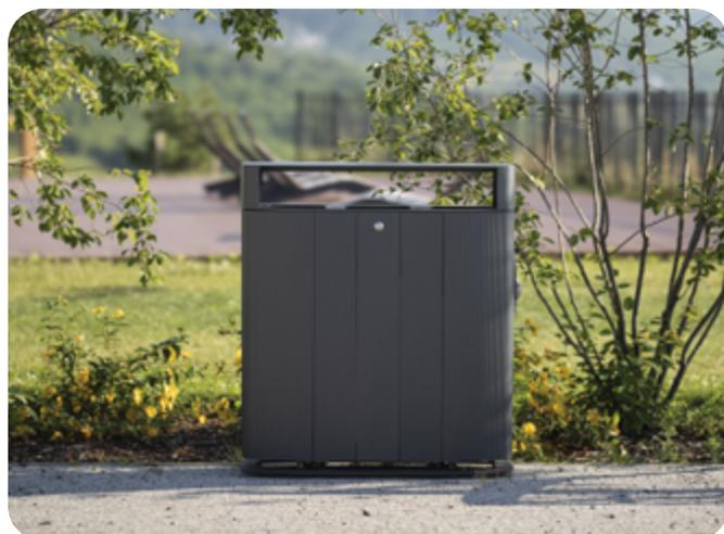
Structure en acier | Toiture en aluminium peint | Habillage en aluminium anodisé ou lames de bois tropical | Bac intérieur en tôle pliée zinguée (3 x 50L) | Ouverture par clé triangulaire 9 mm | Dimensions : 905 x 350 x H1010 mm
