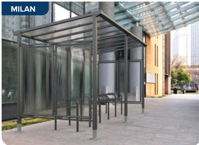
Acier galvanisé peint | Dimensions : L2500 × H2880 × P2434 mm | Capacité : jusqu'à 6 vélos/module (simple ou double face) | Toiture : traverses acier 60x60 mm + polycarbonate alvéolaire 10 mm anti-UV | Bardages optionnels en polycarbonate (fond et latéraux) | Finition : coloris RAL au choix | Extension modulaire par modules de 2500 mm | Fixation : platines avec chevilles fournies | Options : panneaux coupe-vent, supports vélo, barres moto
