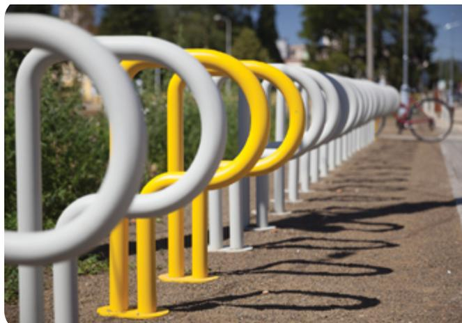
Tube acier Ø60 mm | Hauteur totale : 1100 mm | Poids : 11 kg | Finition : galvanisé + thermolaquage | Fixation : à bétonner ou sur platines (par tiges filetées)
