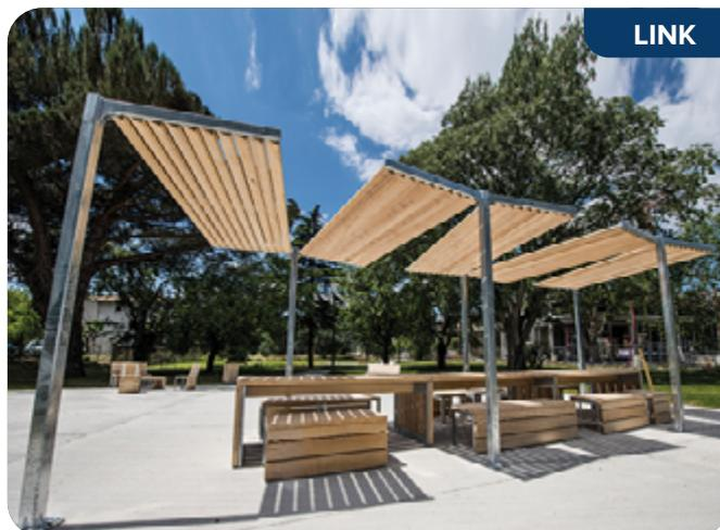
Poteaux en acier galvanisé 80x80 mm | Traverses et renforts en acier galvanisé | Panneaux en frêne naturel, assortis à la gamme Link
