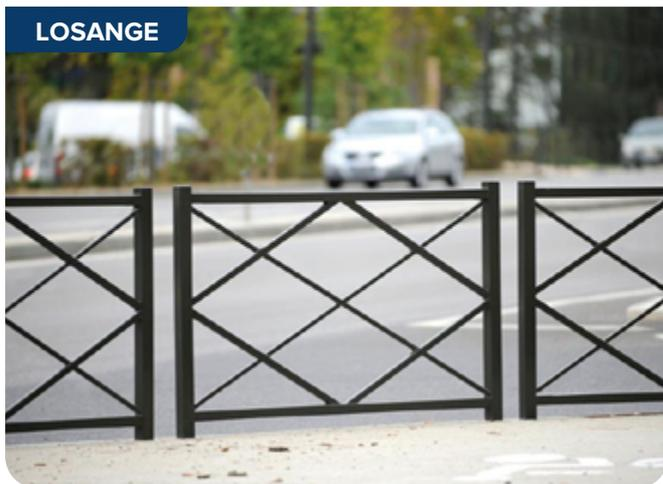
Barrière losange | Montants en acier 50x50 mm, motif losange en 30x30 mm | Longueur 1500mm | Hauteur hors sol 1020 mm | Peint sur zinc selon coloris standards | Fixation : scellement direct (platines en option)
