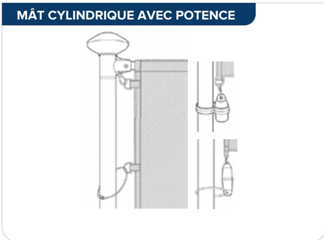
Aluminium extrudé | Pommeau orné | Potence pivotante 360° (1 mètre) pour meilleure visibilité et réduction de l'impact du vent | Finition alu anodisé ou blanc (à préciser)
