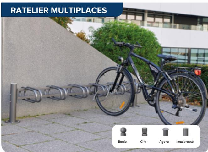
Support à vélos simple face ou double face | Acier tube Ø76 mm, arceaux Ø22 mm | Écart entre arceaux : 50 mm | Finition : peinture sur galvanisation selon coloris standards | Pommeaux au choix : Boule, City, Agora, Inox brossé | Fixation : sur platines
