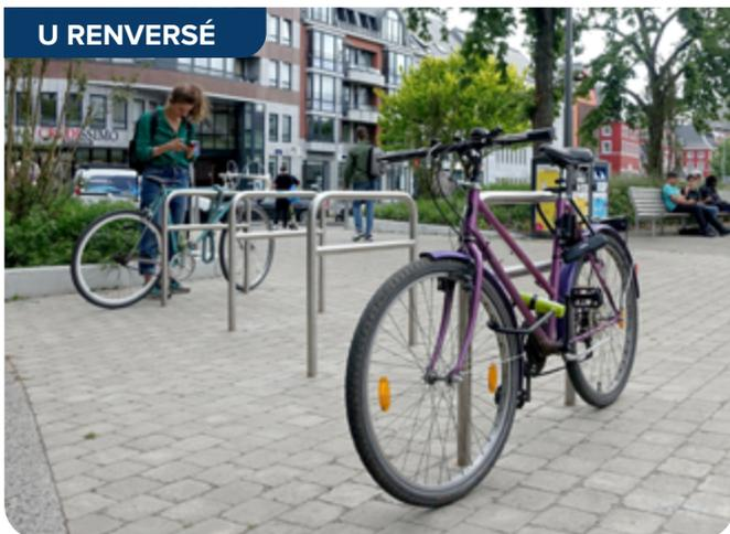
En acier galvanisé ou inox brossé 316L | Avec barre transversale | Hauteur : 1050 mm | Dimensions : version galvanisée tube Ø50 mm largeur 700 mm | version inox tube Ø42 mm largeur 900 mm
