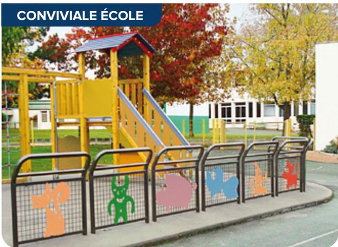
Barrière avec animations enfants | Longueur : 1500 mm | Hauteur totale : 1280 mm | Acier peint sur zinc | Grillage à mailles carrées Ø5 mm | Cadre en tube 40x40 mm, lisses 30x30 mm, lisse haute supplémentaire sécuritaire | Animations en tôle d'acier galvanisé ép. 3 mm | Fixation : scellement direct (compatible kit d'amovibilité)
