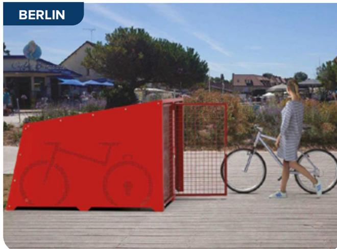
En tôle galvanisée | Portes grillage carré fil Ø5 mm soudé sur cadre acier galva ou peint | Dimensions 1818x2056xH1447 mm | Extension module 2 places largeur 1897 mm | Fermeture par cadenas | Fixation sur platines par goujons d'ancrage (non fournis) | Options : plaque porte, rails sol, arceaux antivol
