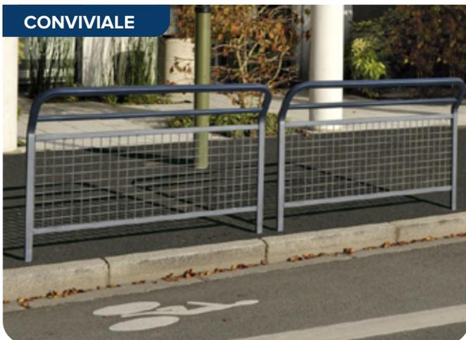
Barrière cintrée avec grillage | Cadre en acier 40x40 mm, lisses 30x30 mm | Grillage en fil Ø5 mm | Longueur 1500 mm | Hauteur totale 1280 mm | Peint sur zinc selon coloris standards | Fixation : scellement direct | Compatible avec kit d'amovibilité
