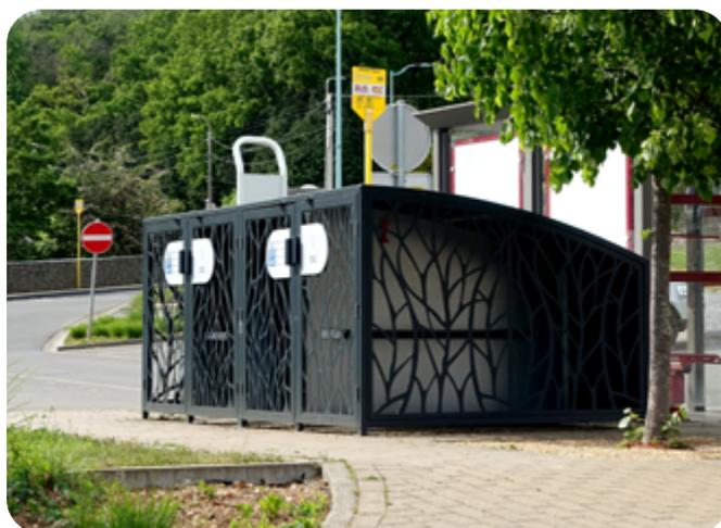
Structure en tube acier 40x40x2mm galvanisé à chaud et peint | Toiture en tôle acier ép. 2mm | Finition peinture polyester thermodurcissable (RAL au choix, résistante aux UV) | Fixation : sur dalle ou enrobé | Porte ajourée avec motif perforé | Autres habillages disponibles sur demande | Options : porte battante ou coulissante, mât signalétique, affiche d'utilisation, guide vélo anti-deux-roues motorisés.
