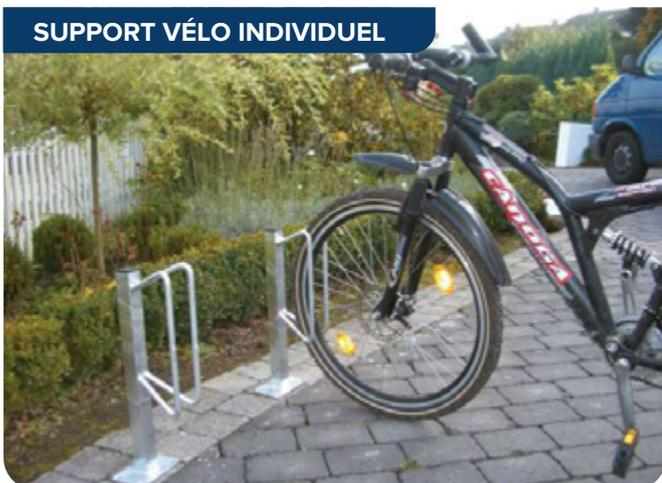
Support à vélos tube 40x40 mm avec 2 arceaux soudés en acier rond Ø12 mm | Acier galvanisé à chaud | Fixation : à bétonner, à cheviller ou à fixer au mur (modèles différents) | Simple ou double face (modèles à bétonner/cheviller) | Angle 45° ou 90° (modèle mural) | Hauteur hors sol : env. 500 mm
