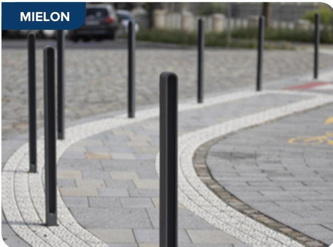
Fonte d'aluminium moulée | Section : 60x72 mm | Fixation : À visser sur platine (hauteur hors sol : 1150 mm) ou avec platine enfouie (hauteur hors sol : 1050 mm)
