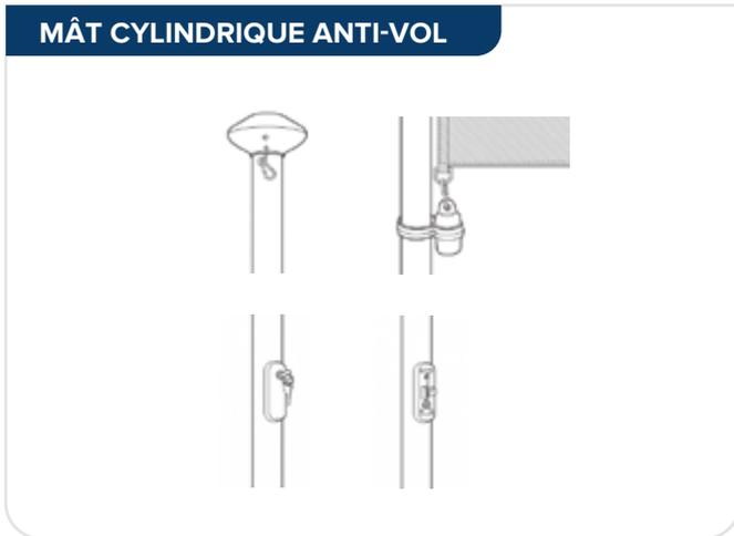
Aluminium extrudé | Pommeau avec poulie sécurisée pour manipulation facile sans blocage | Cordage intérieur anti-vol | Réduction des nuisances sonores | Finition alu anodisé ou blanc (à préciser)
