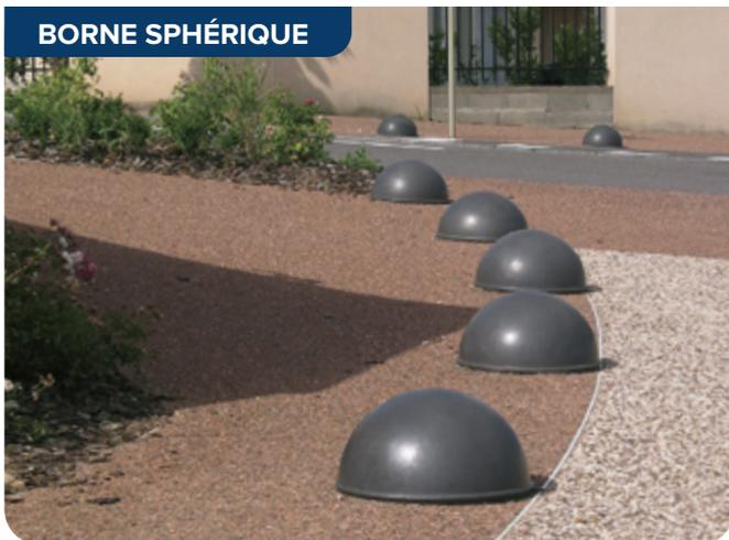
Fonte monobloc métallisée | Ø400 mm | Hauteur hors sol : 215 mm | Fixation : 2 tiges d'ancrage Ø12x150 mm | Peinture RAL au choix
