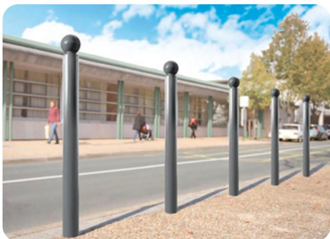
Potelet acier peint sur zinc | H. hors sol 1000 mm (1180 mm total) | Tube Ø76/114 mm, ép. 3 mm | 4 modèles (City, Agora, Boule, Inox brossé) | Pommeaux fonte, alu ou inox | Fixation scellement direct (180 mm), platines optionnelles
