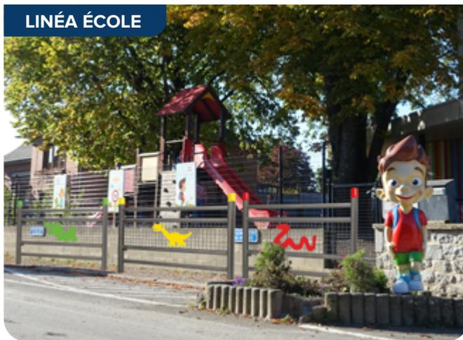
Barrière avec animations colorées | Longueur : 1572 mm | Hauteur hors sol : 1100 mm | Acier peint sur zinc | Cadre Ø76 mm, lisses Ø50 mm | Grillage à mailles carrées Ø4 mm | Fixation : scellement direct (compatible kit d'amovibilité) | Couleurs fixes par modèle : Dino (RAL 1021), Serpent (RAL 3020), Croco (RAL 6018)
