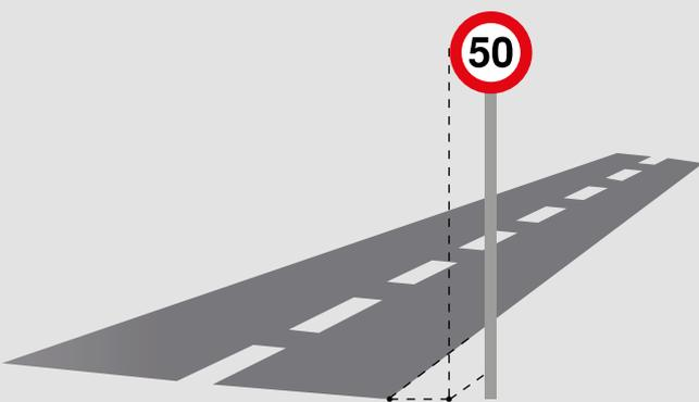
Les signaux doivent être placés à 0,75m minimum du bord de la chaussée si celui-ci n'est pas délimité par une bordure saillante ; et à 0,50m dans le cas contraire.
