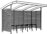
Toiture en polycarbonate & Parois arrière et latérales en lames de bois
