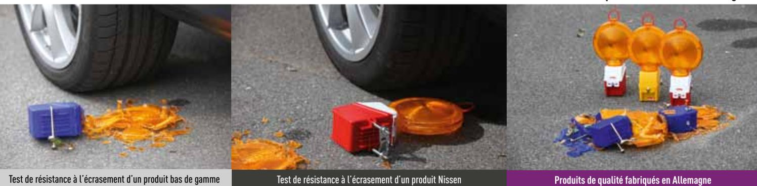
Test de résistance à l'écrasement d'un produit bas de gamme
